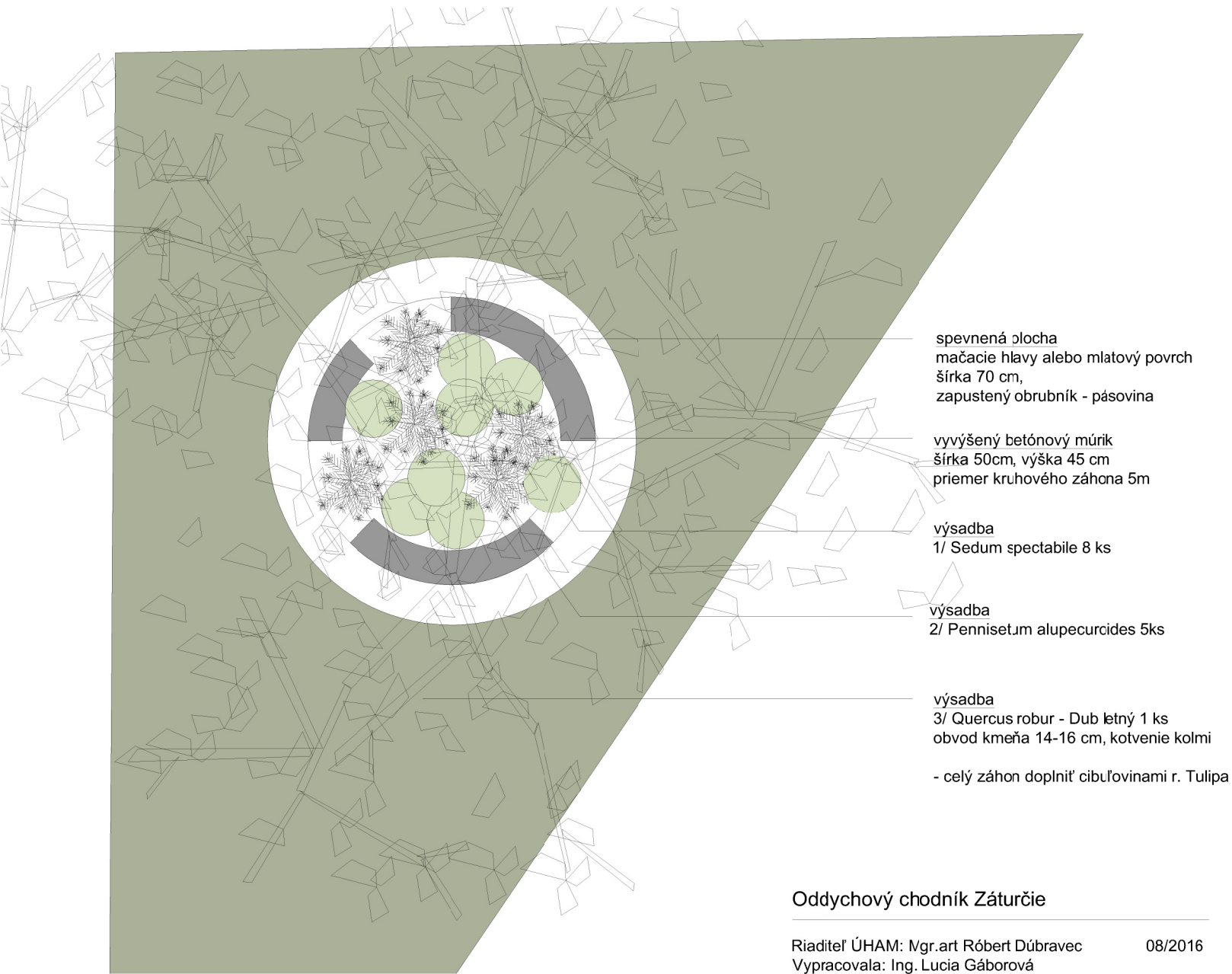
Detail umiestnenia pamätného stromu s podsadbou M 1: 100
